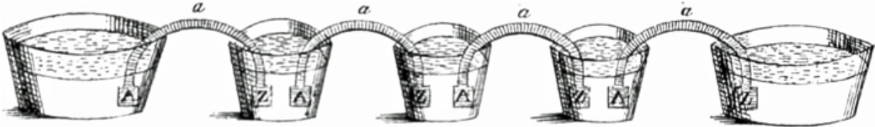
Abb. 36. Voltas Becherapparat.
