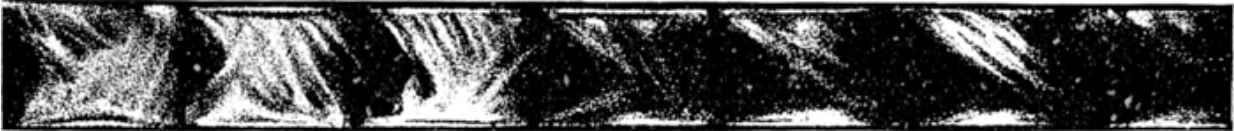
Abb. 61. Feddersens Nachweis der elektrischen Schwingungen.
